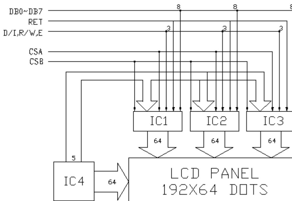
IC4 为行驱动器。IC1, IC2, IC3 为列驱动器。IC1, IC2, IC3, IC4 含有以下主要功能器件。了解如下器件有利于对 LCD 模块之编程。
