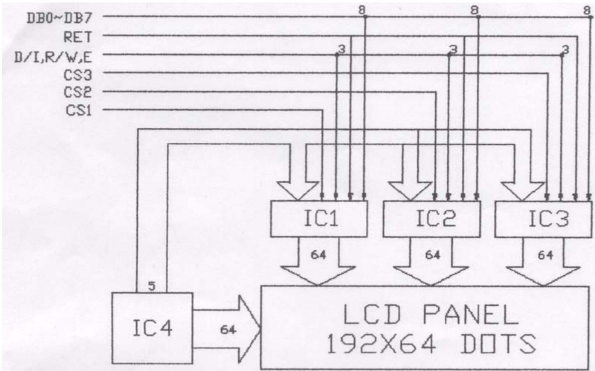
IC4 为行驱动器。IC1, IC2, IC3 为列驱动器。IC1, IC2, IC3, IC4 含有以下主要功能器件。了解如下器件有利于对模块编程。
